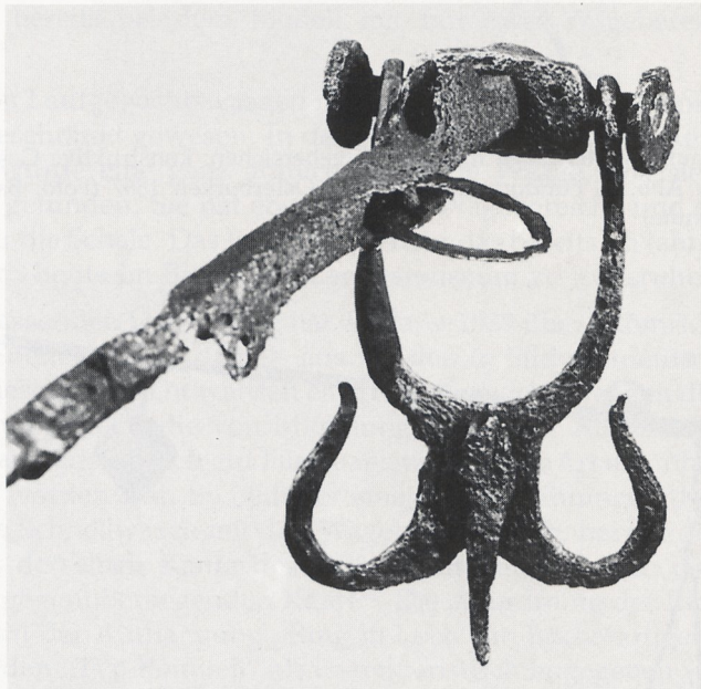
Abb. 8 Laufgewichtswaage nach Abb. 7; beweglich angeordnetes und an Achse gelagertes Zwischengelenk für Handhabe der Waage. Aufhängung der Waagschale an drehbar gelagertem Zwischengelenk mit Querbalken und schneidenförmigem Gegenlager, Sicht von rückwärts (Foto: Heimatmuseum Tuttlingen)
