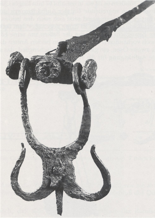
Abb. 9 Laufgewichtswaage nach Abb. 7; Zwischengelenk für Waagschale, Sicht seitlich vorn (Foto: Heimatmuseum Tuttlingen)
