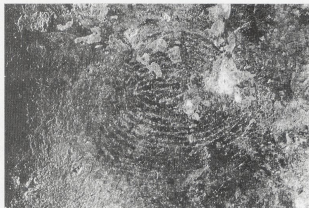
Abb. 4 Aufkorrodierter Fingerabdruck im Halsbereich.
