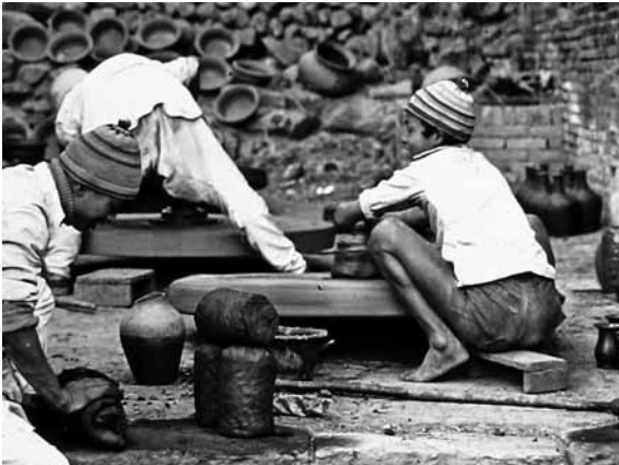
25 Bhaktapur, Pottery Square, Rammandir Road (Kathmandu, Nepal). Töpfer an der niedrig gelagerten Stabscheibe. Der Bewegungsablauf, die vornüber gebeugte Stellung und der flache Hocker sowie der Drehstab auf dem Boden links neben dem Töpfer entsprechen dem Töpferbild von Typ 1 - Speicher/Pompeji I [Abb. 24]. Die Scheibe läuft nach dem Kreiselprinzip, d. h., der Drehdorn ist im Zentrum unter der Schwungscheibe fixiert, die Spurpfanne sitzt auf dem Boden.
