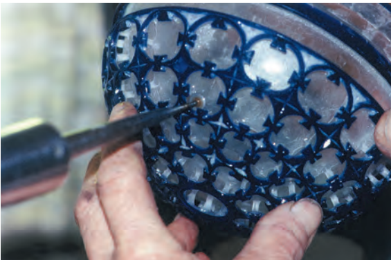
4 Hinterschleifen des Netzwerkes und Glätten des Hintergrundes mit der Stirnseite des Schleifrädchens.
