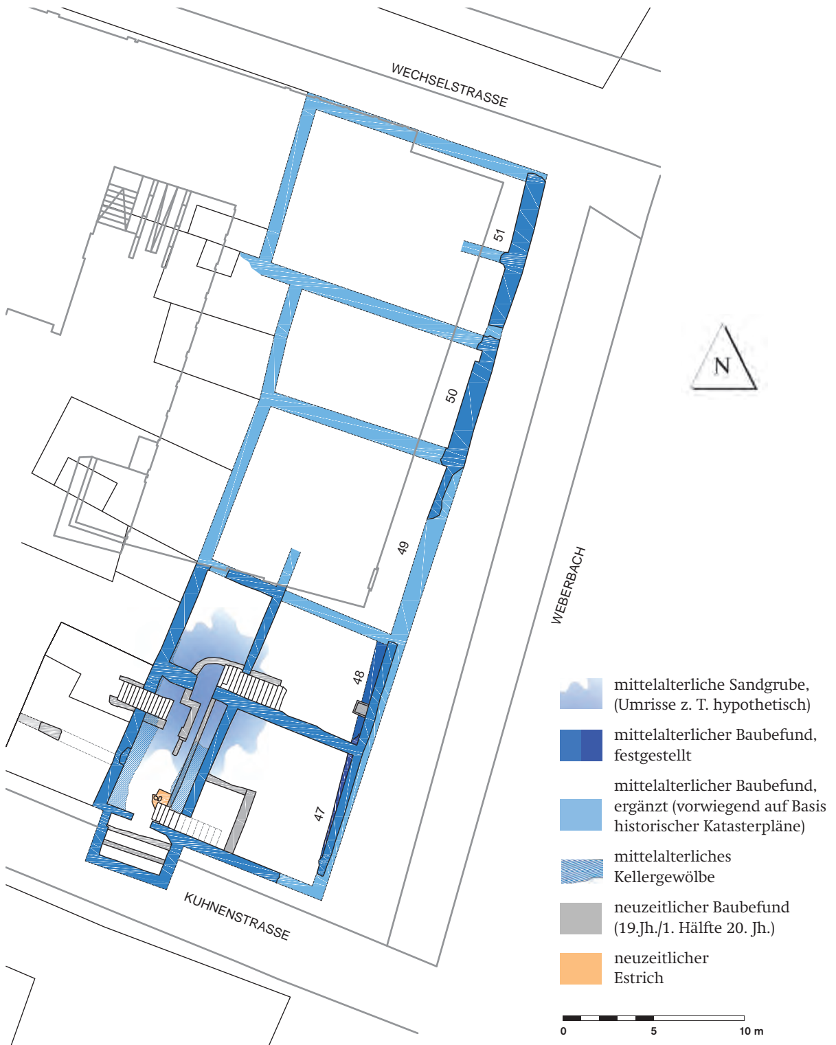
52 Trier, Weberbach 50. Lageplan der mittelalterlichen und neuzeitlichen Befunde. Moderne Bebauung (Stand 2009) mit grauer Linie unterlegt, historische Parzellenstrukturen mit schwarzer Linie (CAD-Plan: H. Comann).
