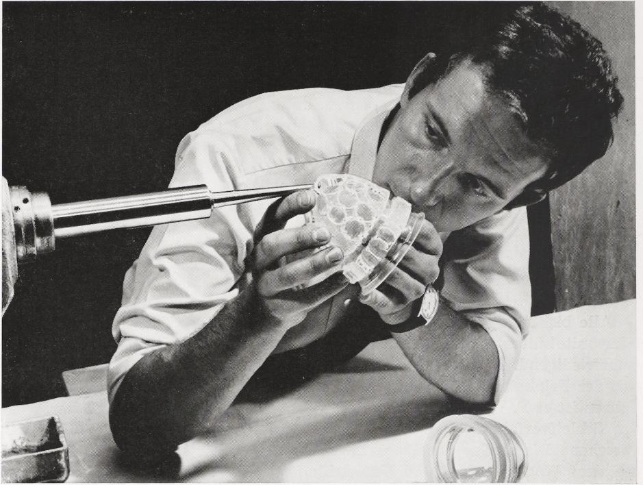
Abb. 6 Anfertigung einer Nachbildung des Diatretglases von Daruvar nach römischer Schlifftechnik. F. W. Schäfer beim Einsäumen des Standringes mit Hilfe einer starren Welle
