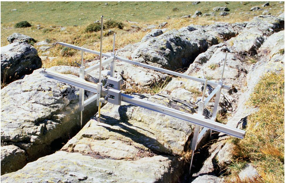
Abb. 9 Das Messgerät ermöglicht in einem ersten Schritt die Aufnahme von Wegprofilen, die ihrerseits als Basis für die Ermittlung von Spurweiten dienen.
