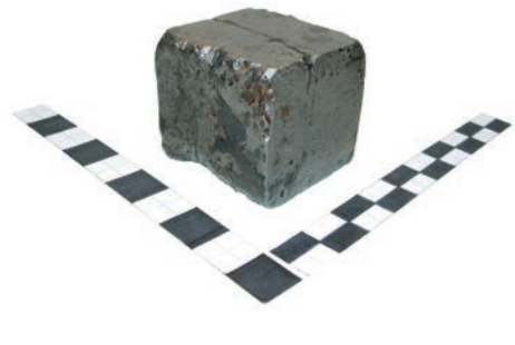
Abb. 2: Würfel 1: Deutlich erkennbar ist die glatte „Stirnfläche“ mit dem ins Körperinnere einziehenden Schmiedefalz. Aufnahme des Autors.
