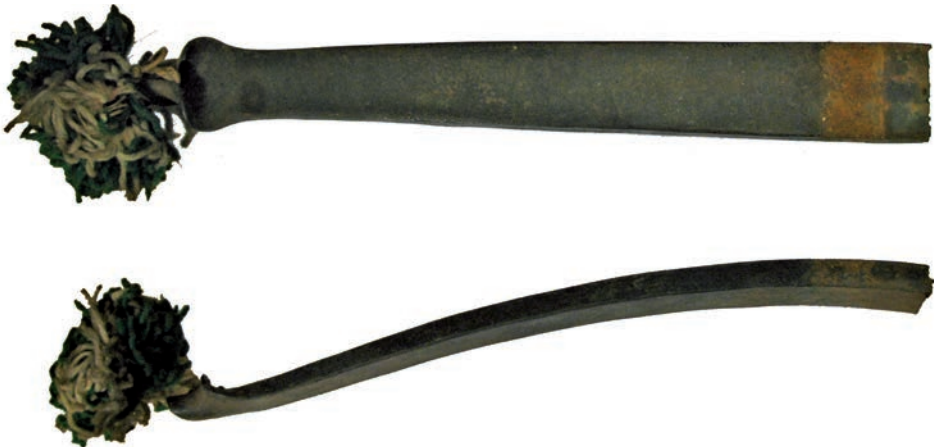
Abb. 1: Bogenbruchstück, ursprünglich aus dem Besitz der Weimarer Armbrustschützengesellschaft, Gesamtlänge 320 mm, Querschnitt an Bruchstelle nahe der Bogenmitte 39,4 x 12,5 mm, Querschnitt an schwächster Stelle vor dem Sehnenlager 28,6 x 7,4 mm.
