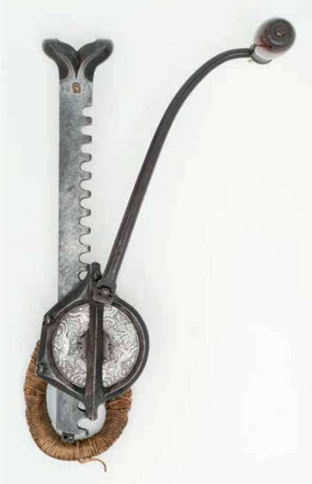
Abb. 18 a: Zahnstangenwinde, Detail - eingeschlagene Jahrzahl 1584, Marke in Messing: Hahn mit einem kleinen Pentagramm.
